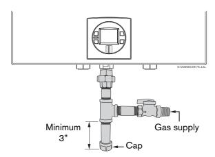
Fig. 25 Gas connection (drip leg)
